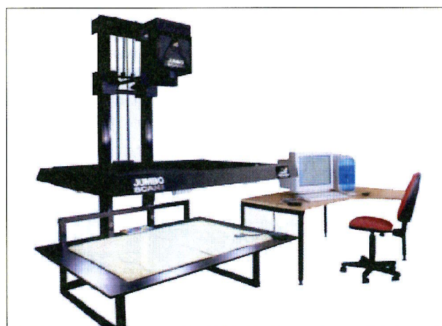
Figure 571. Scanner à caméra Jumboscan pour scanner des plans de 5 x 3 m. Précision de 0,005 % © Lumière Technology
